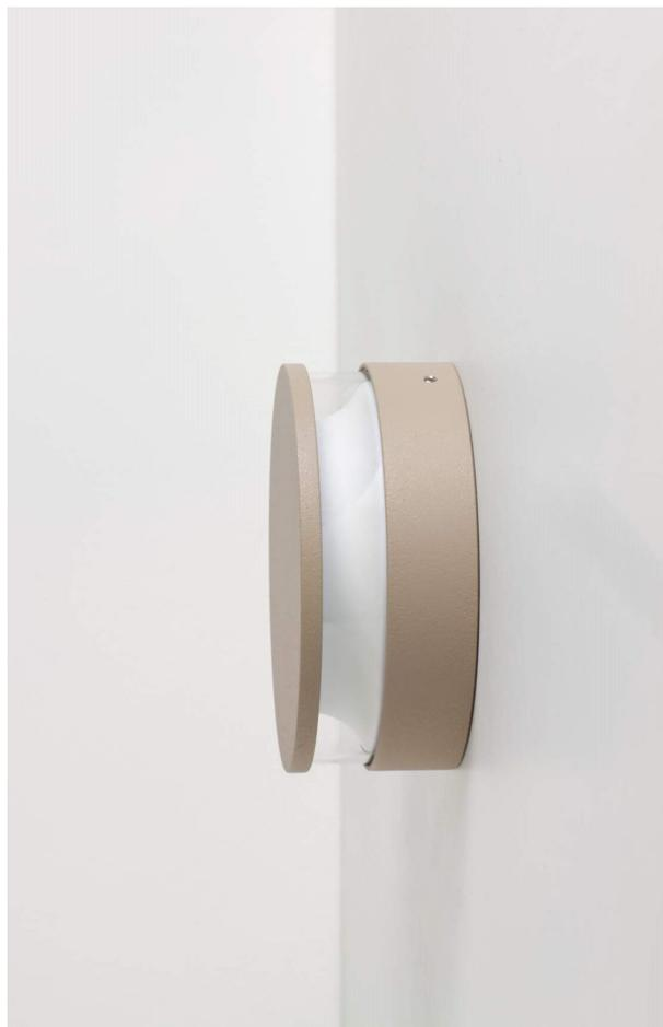
Apparecchio per applicazione a parete disponibile con riflettore in alluminio bianco o nero, emissione radiale. Realizzato in alluminio pressofuso EN47100 verniciato nei quattro colori standard a polvere poliestere su fondo trattato per la resistenza alla corrosione. Fornito con staffa di montaggio in acciaio inox e connettori Gel IP a garanzia della protezione. Schermo in policarbonato stabilizzato Uv e guarnizioni in silicone di tenuta.
