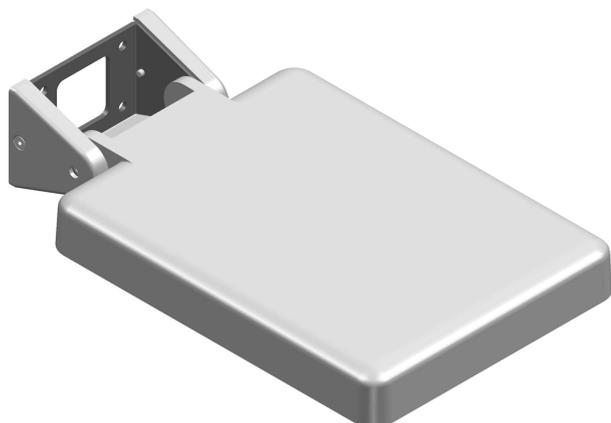
Proiettore per installazione a parete, soffitto, palo o pavimento con corpo e cover in alluminio pressofuso EN47100, disponibile nei quattro colori standard verniciati a polvere poliestere su fondo trattato per la resistenza alla corrosione. La versione a 16 led monta lenti con fasci 30°, 65°, asimmetrico o stradale. Sigillato da un vetro trasparente temprato serigrafato nero, fissato meccanicamente con colla siliconica.
