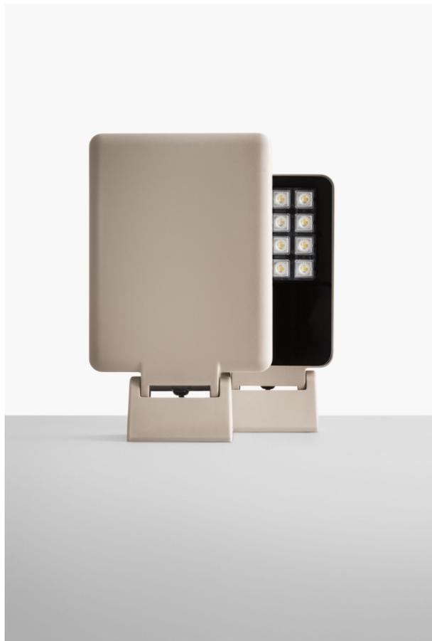
Proiettore per installazione a parete, soffitto, palo o pavimento con corpo e cover in alluminio pressofuso EN47100, disponibile nei quattro colori standard verniciati a polvere poliestere su fondo trattato per la resistenza alla corrosione. La versione a 16 led monta lenti con fasci 30°, 65°, asimmetrico o stradale. Sigillato da un vetro trasparente temprato serigrafato nero, fissato meccanicamente con colla siliconica.
