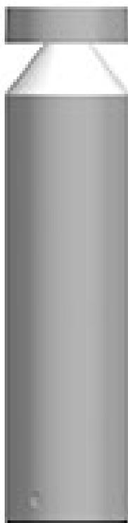
Bollard per installazione a pavimento o terreno realizzato in alluminio pressofuso EN47100 (la testa), palo in alluminio estruso realizzato in tre altezze H.160mm, H.500mm, H.800mm e base in materiale plastico caricato con fibra di vetro. Disponibile nei quattro colori standard verniciati a polvere poliestere su fondo trattato per la resistenza alla corrosione, coni riflettori verniciati solo in bianco o nero. Vetro temprato trasparente fissato meccanicamente con colla siliconica
